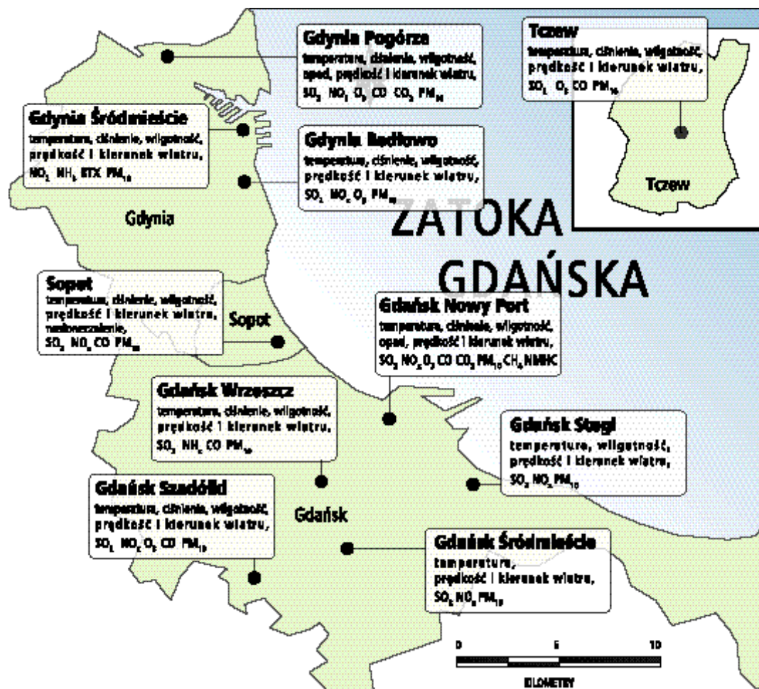
Ryc.1. Lokalizacja i wyposażenie stacji sieci ARMAAG
