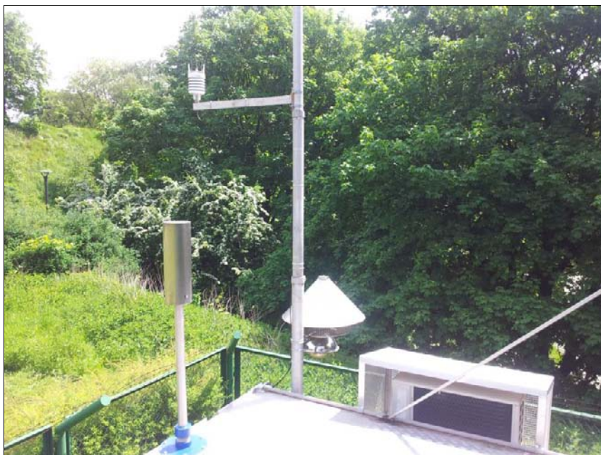
Ryc.6. Stacja pogodowa Vaisala WXT 520 na stacji AM1 Gdańsk Śródmieście
