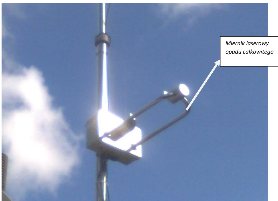
Ryc.2. Miernik laserowy opadów na stacji AM6
