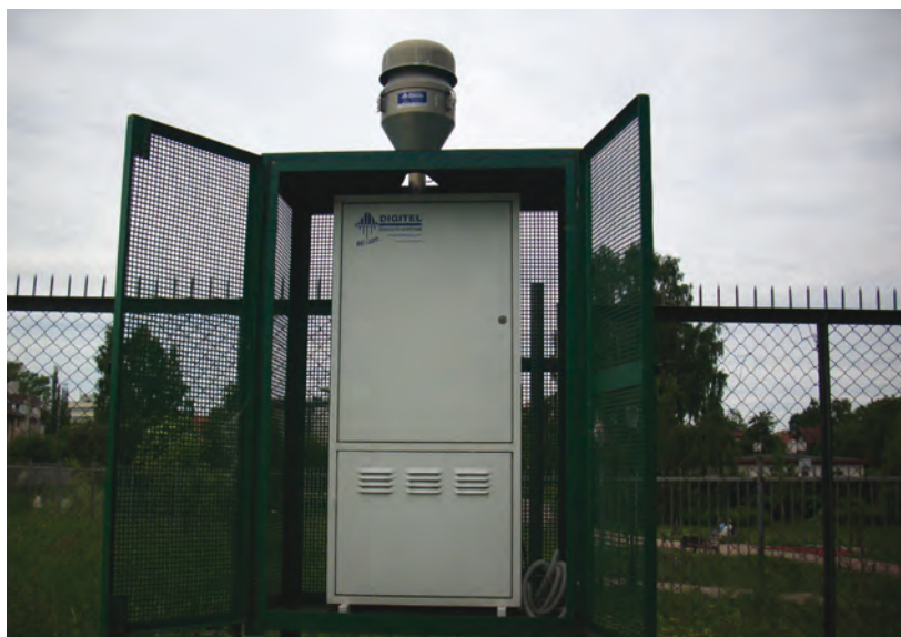
Ryc. 7. Referencyjny pobornik pyłu VHS na stacji AM8
